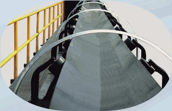
Fabricados bajo la norma CEMA, ideales para el manejo de materiales como carbon, calizas, grava, arcilla, cementos, etc.
